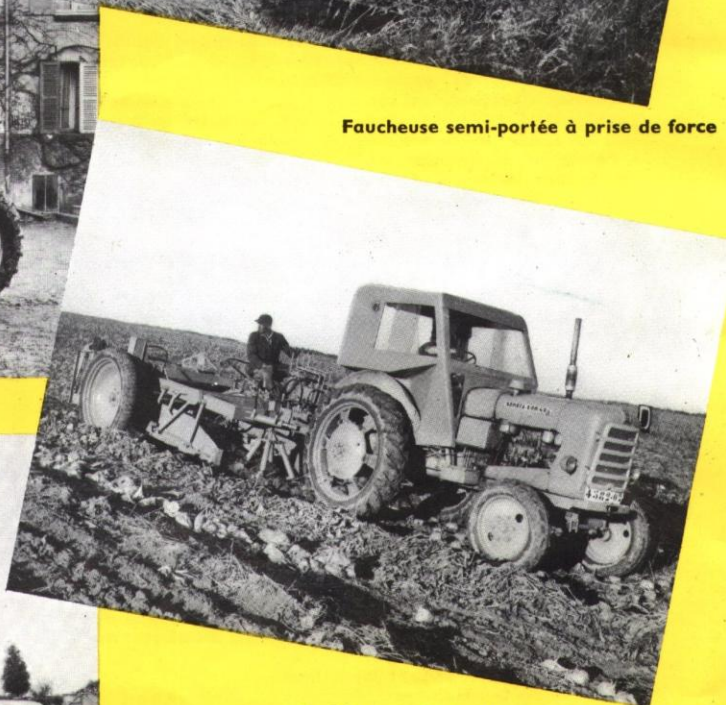
Arracheuse de betteraves (3 rangs) et pommes de terre (2 rangs)
