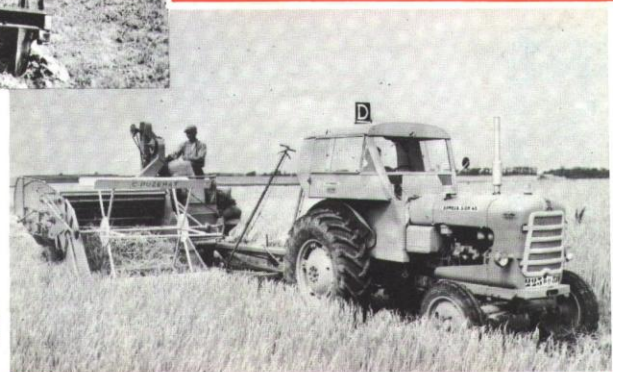
Moissonneuse-batteuse tractée, à prise de force
