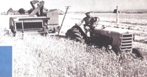
Moissonneuse-Batteuse BP 180 à prise de force, avec trémie de 980 l.
