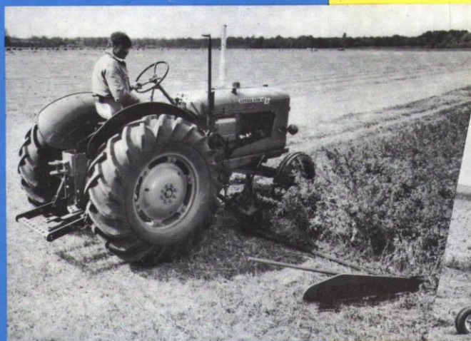
Faucheuse portée latérale commandée par prise de force
