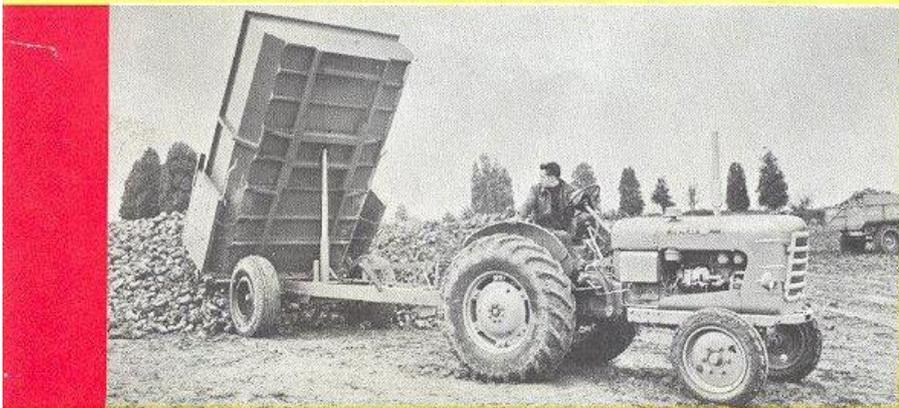
SOM. 40 avec semi-remorque à basculement hydraulique.
