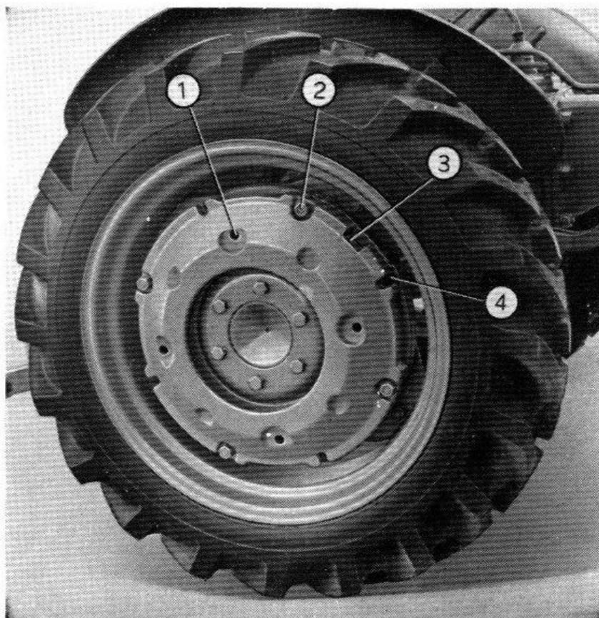
**Fig. 20. — Masses d'alourdissement pour les roues arrière.**
