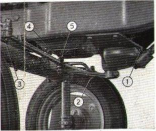
Accouplement de la direction : Graisser **toutes les 10 heures** les 4 points d'articulation. Shell Retinax A ou CD. Vérifier le niveau du moteur **toutes les 80 heures** par le bouchon (1).
