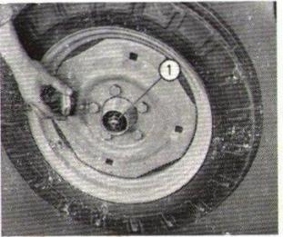
Moyeux des roues avant : **Toutes les 600 heures**, remplir le couvercle de Shell Retinax A ou H.
