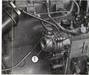
Moteur : **Toutes les 10 heures**, contrôler le niveau et le rétablir jusqu'au « maxi » de l'huile neuve Shell Rotella T de viscosité convenable selon la température de l'huile neuve Shell Rotella T de viscosité convenable selon la température (voir nota 1).
