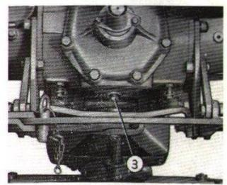
Boîte de vitesses et réducteur central : Vidanger par le bouchon (3). **Toutes les 1.200 heures**, remplacer avec de l'huile Shell Dentax 90.
