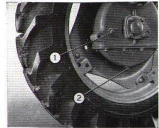
Réducteurs des roues motrices : **Toutes les 240 heures**, vérifier le niveau par le bouchon (1). **Toutes les 1.200 heures**, vidanger par le bouchon (2) et faire le plein avec de l'huile Shell Dentax 140.
