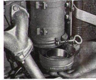
Filter à air : Vérifier le niveau **toutes les 20 heures**. Rétablir le niveau ou changer l'huile si nécessaire. Même huile que le moteur.
