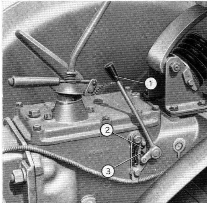
**FIG. 9. — Levier de commande de la prise de force.**
