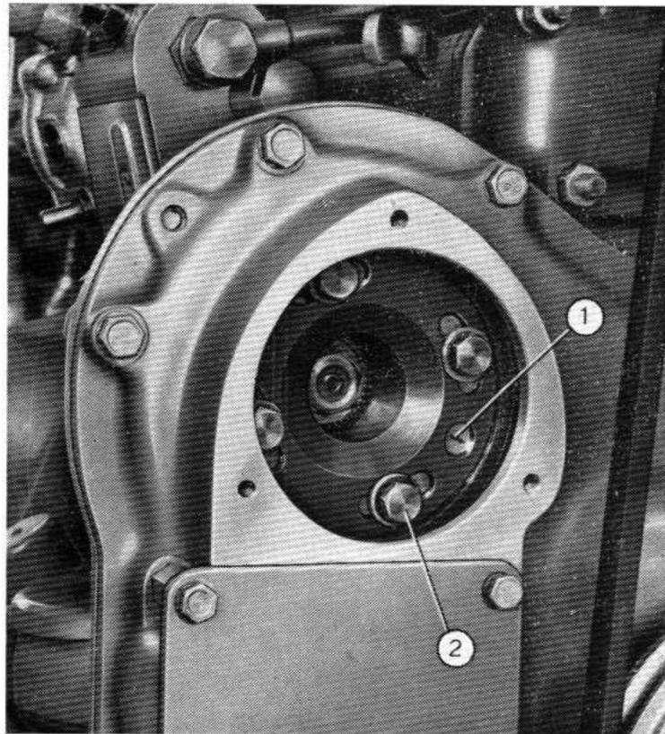
7° Porter le levier d'accélération à mi-course et amener le cylindre N° 1 au temps de compression en tournant le volant moteur.
