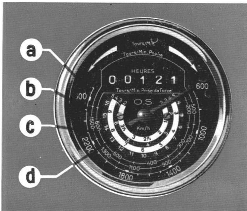
FIG. 15. — Horotachymètre
