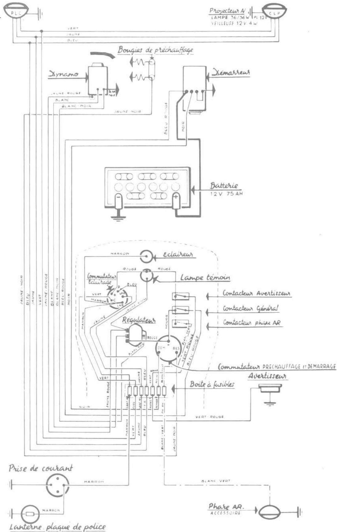
FIG. 29. — Schéma de l'installation électrique.
