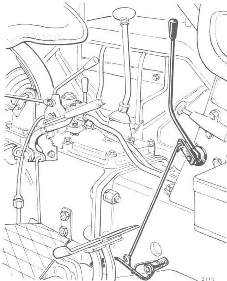
**FIG. 8. —** Commande d'accélérateur au pied, et à main.
