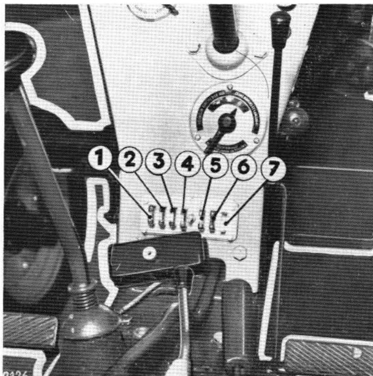
**FIG. 28. — Boîtier à fusibles.**
