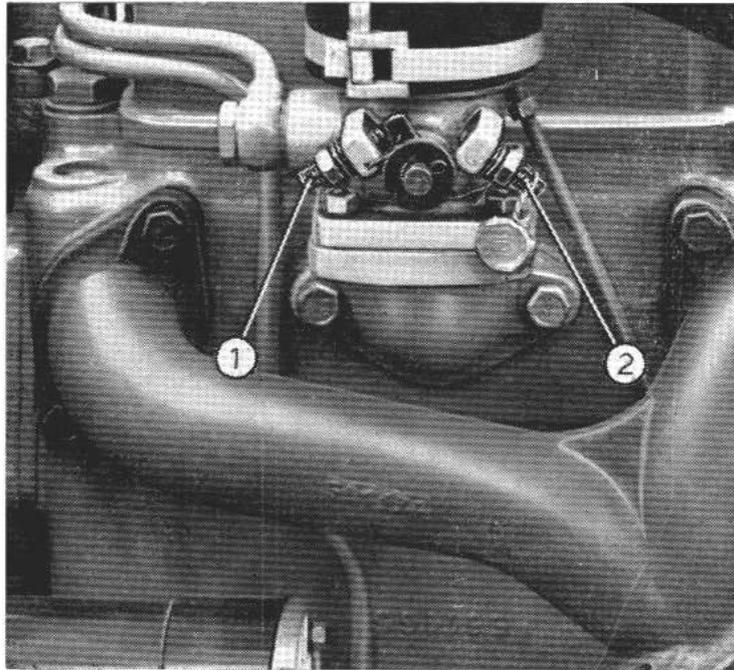
Pour le réglage ne pas se fier aux indications de l'horotachymètre, mais prendre le régime moteur à l'aide d'un tachymètre à main en bout du centrifugeur d'huile (**pièce d'adaptation à réaliser**), ou sur la prise de force (**dans ce cas multiplier le régime trouvé par 3,93**).
