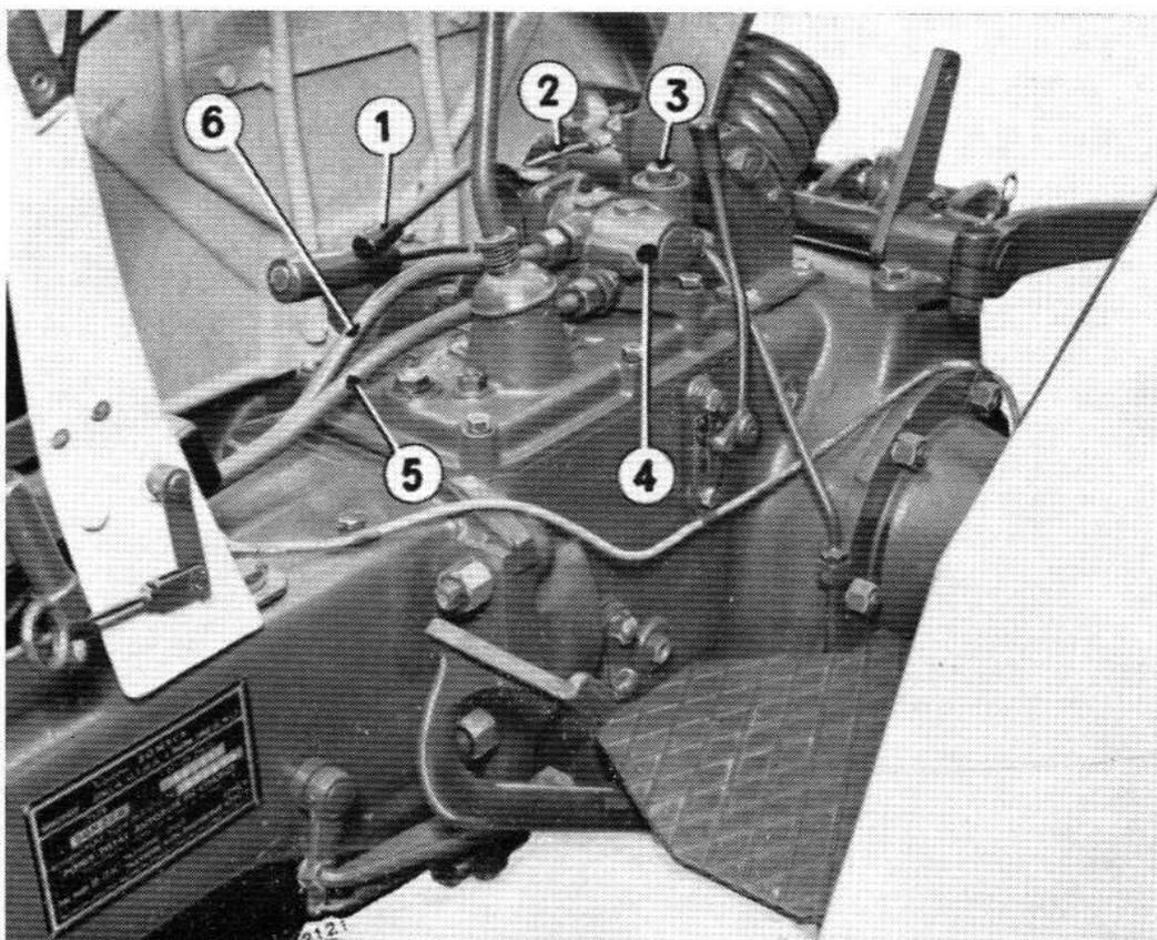
**FIG. 19. — Distributeur et commande du relevage hydraulique**
