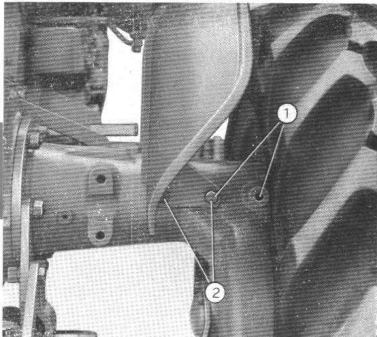
*Nota.* — Dans le cas d'utilisation de la voie minimum il est nécessaire de démonter les sièges des ailes et de déplacer ces dernières comme l'indique la figure 17.
