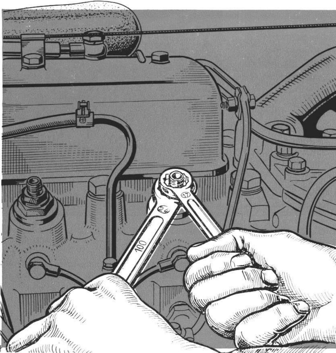
**FIG. 26. Dépose des injecteurs.**
