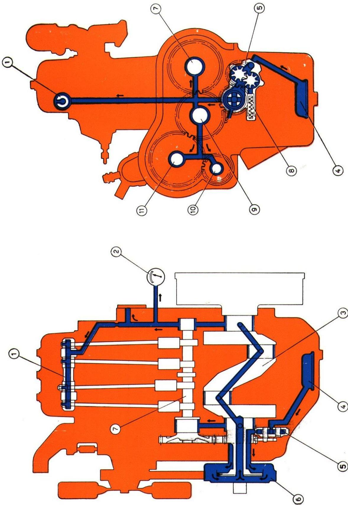
**Schéma de la lubrification du moteur.**
