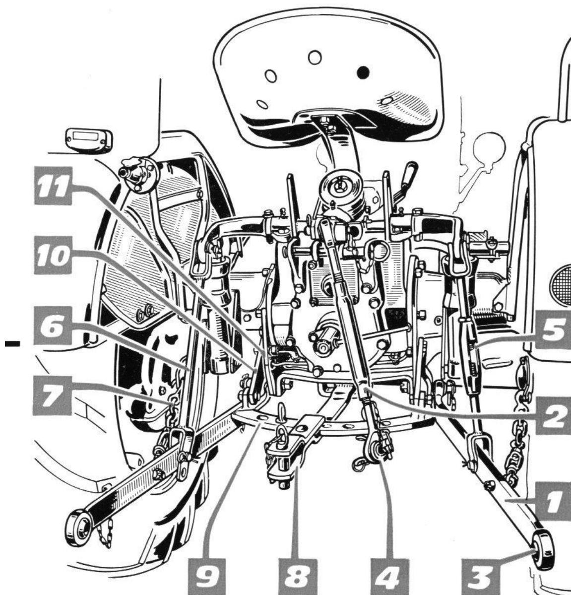
**FIG. 19. — Dispositif d'attelage 3 points.**
