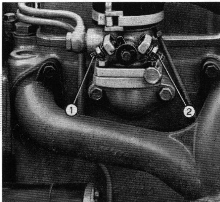
Pour le réglage prendre le régime moteur à l'aide d'un tachymètre à main en bout du centrifugeur d'huile (**pièce d'adaptation à réaliser**), ou sur la prise de force (**dans ce cas multiplier le régime trouvé par 3,93**).
