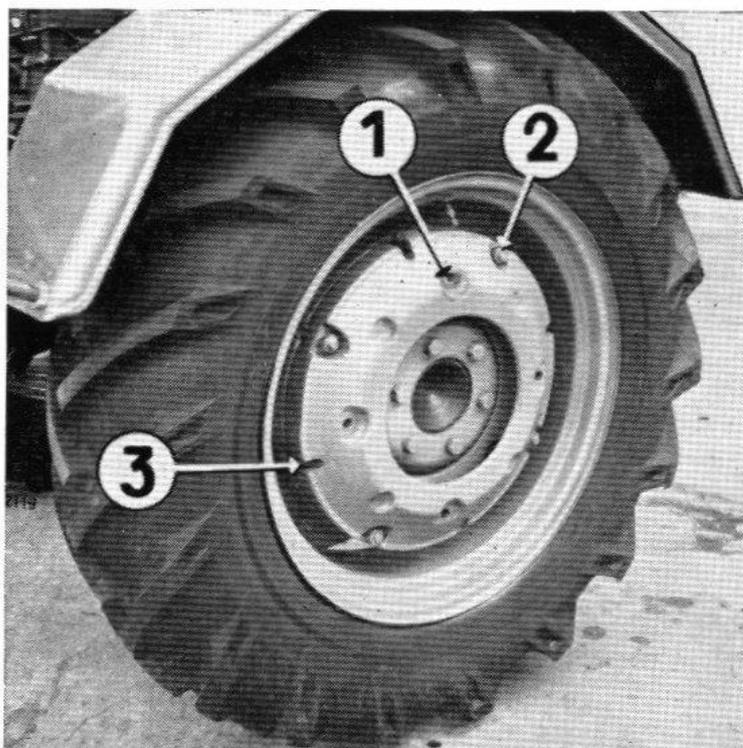
**FIG. 13. — Masses d'alourdissement pour les roues arrière.**
