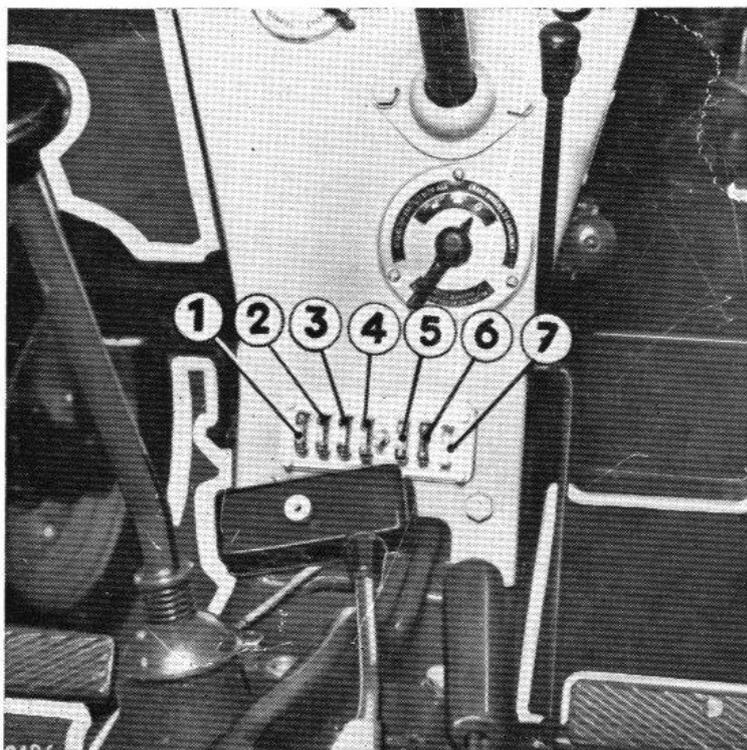
**FIG. 26. — Boîtier à fusibles.**
