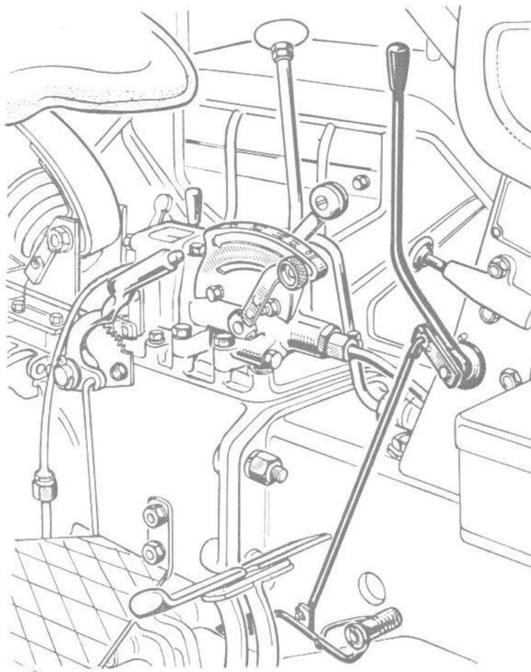
**FIG. 8. – Commande d'accélérateur au pied, et à main.**
