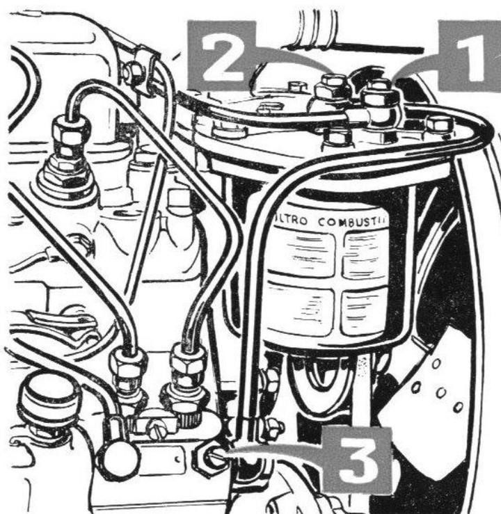
**FIG. 10. — Purge d'air du filtre à combustible et de la pompe d'injection.**
