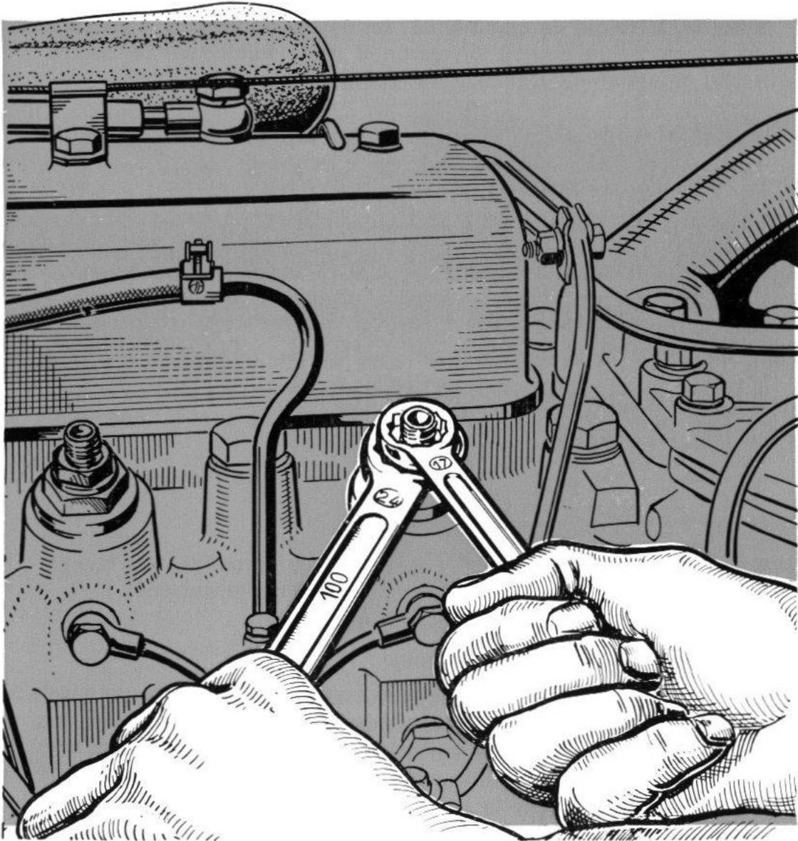
**FIG. 24. Dépose des injecteurs.**
