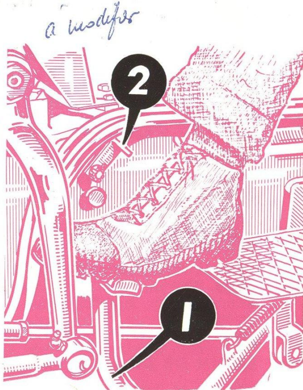
FIG. 6 B. — Pédale de débrayage (1) avec butée (2) libérant la course totale.
