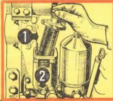
**12 FILTRE AUTO-NETTOYEUR** - Démontez et nettoyez le filtre à lamelles (1) à l'essence ou au pétrole. Nettoyez également le corps du filtre, après l'avoir vidangé (bouchon de vidange 2).
