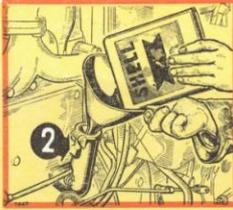
**10 RENIFLARDS MOTEUR** - Nettoyer au pétrole le reniflard (1) incorporé au bouchon du tube de remplissage, ainsi que le reniflard (2) situé à la partie supérieure du cache-culbuteurs.
