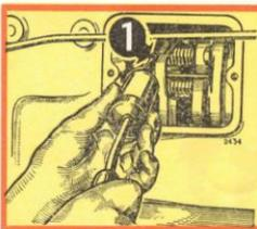
**15 POMPE D'ALIMENTATION** - Desserer l'écrou moleté 1. Déposer la cuve en verre et nettoyer au pétrole le filtre 2.
