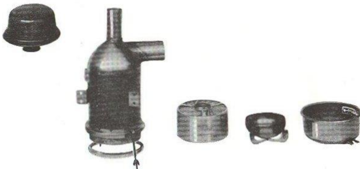
Fig. 19. — Filtre à air démonté.
