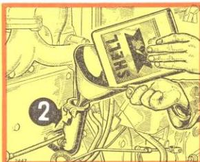
**11 RENIFLARDS MOTEUR** - Nettoyer au pétrole le reniflard (1) incorporé au bouchon du tube de remplissage, ainsi que le reniflard (2) situé à la partie supérieure du cache-culbuteurs.
