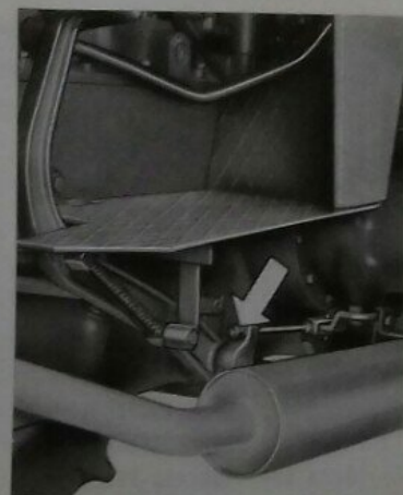
Fig. 28 B - Comando freno sinistro.
