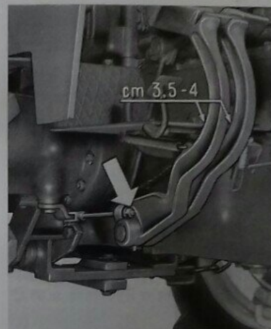
Fig. 28 A - Comando freno destro.
