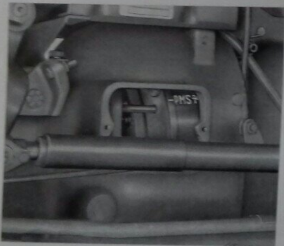
Fig. 39. - Riferimento « PMS 1-4 » sul volano motore, indicante il punto morto superiore degli stantuffi n. 1 e 4.
