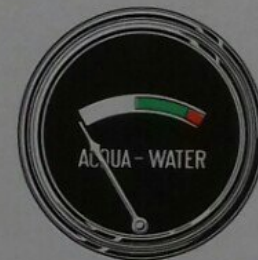
Fig. 9. - Indicatore temperatura acqua raffreddamento motore.
