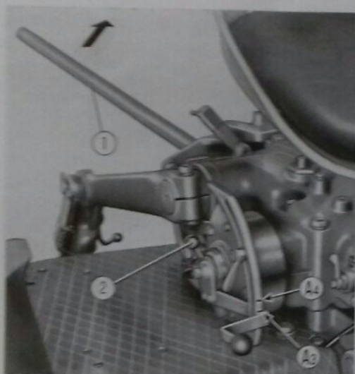
Fig. 51. - Verifica del campo di intervento dello sforzo controllato.
