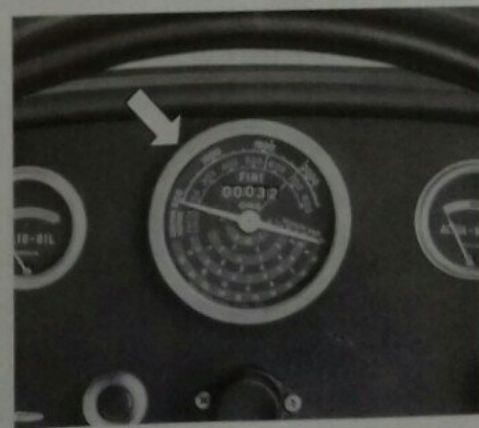
Fig. 5. - Indicatore giri motore e presa di forza, velocità di marcia e contaore.
